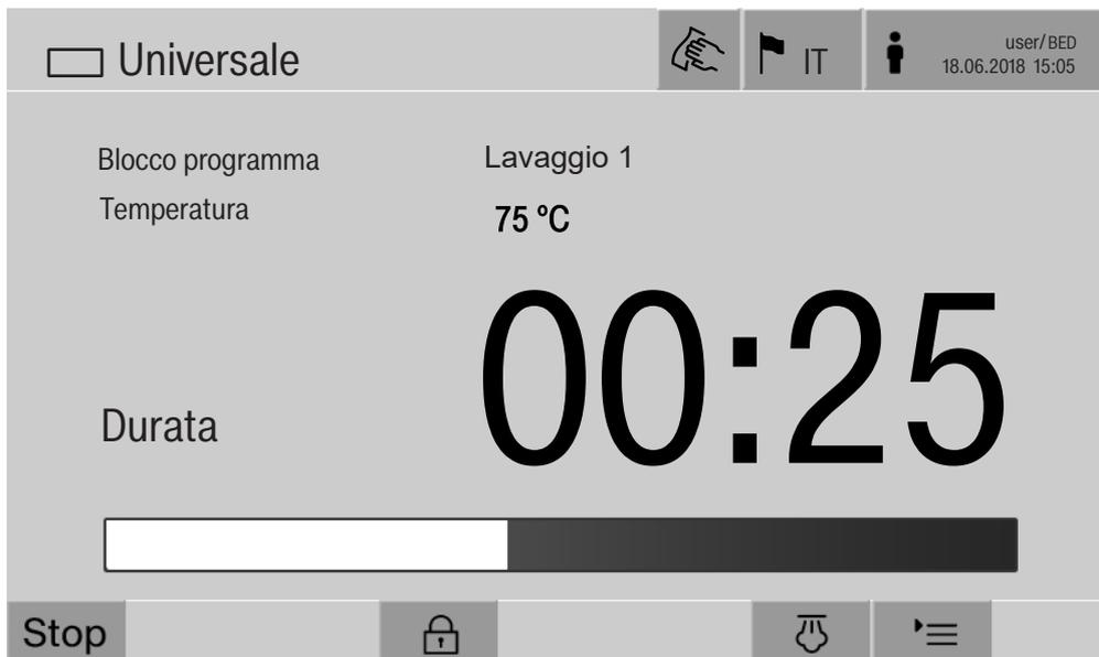
A display vengono visualizzati inoltre il blocco programma attuale e la temperatura raggiunta.
