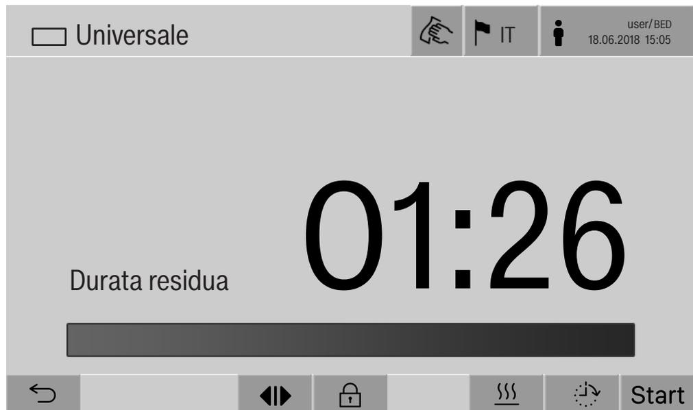
nella riga in alto sono visualizzati il pittogramma del supporto di carico e il programma selezionato.
