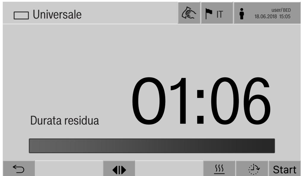
Dopo aver selezionato il programma viene visualizzata la durata residua del programma di trattamento scelto. Se il parametro Visualizzare durata residua nell'interfaccia web non è attivato, dopo l'avvio del programma l'indicazione passa alla Durata già trascorsa del programma.
