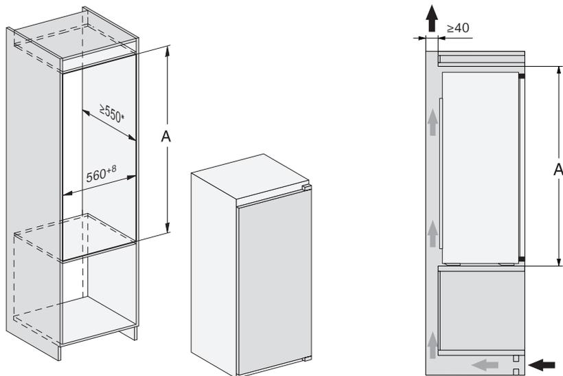
\* O consumo de energia declarado foi determinado num nicho com uma profundidade de 560 mm. O aparelho de frio é totalmente funcional com uma profundidade de 550 mm mas tem um consumo de energia ligeiramente superior.
