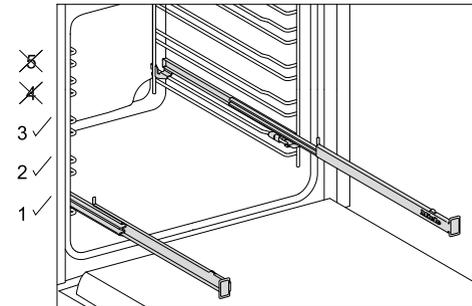
Les rails coulissants FlexiClips peuvent uniquement être placés aux niveaux 1, 2 et 3.
