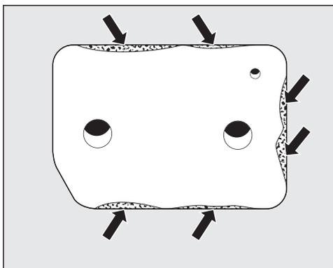
**⚠** Danni dovuti a un filtro zoccolo danneggiato o usurato. Lo scambiatore di calore si ostruisce e si può verificare un danno. Controllare il filtro zoccolo come descritto al par. “Sostituire il filtro zoccolo” del capitolo “Risoluzione dei problemi”. Sostituire il filtro zoccolo, se necessario.
