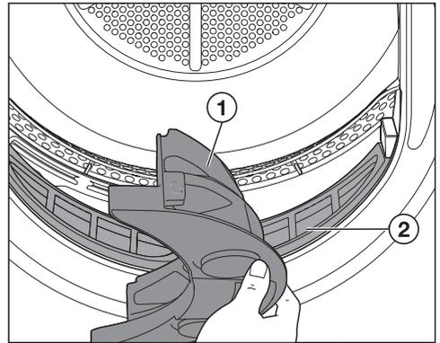
Pulire entrambi i filtri impurità ① e ② dopo ogni programma di asciugatura.
