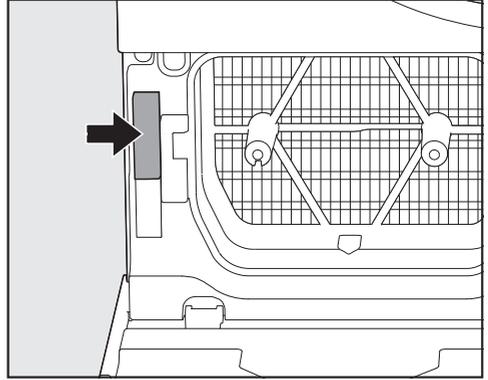
Estraendo il supporto si attiva un elemento di sicurezza (freccia). L'elemento di sicurezza impedisce la chiusura dello sportellino zoccolo senza supporto inserito. Inserendo il supporto si disattiva l'elemento di sicurezza.
