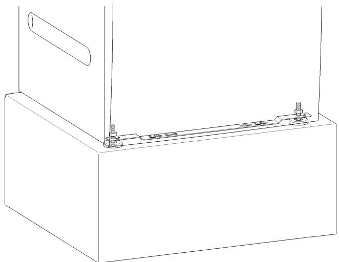
L'appareil est fixé au sol par les deux pieds avant à l'aide de l'étrier de fixation joint. Le matériel de fixation est prévu pour une fixation par goujons sur le sol en béton.
