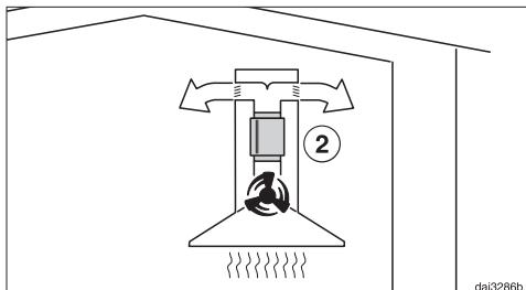
Kod načina rada na kruženje zraka, prigušivač buke se postavlja između ispušnog otvora i skretnice zraka (2). Provjerite prostor ugradnje.
