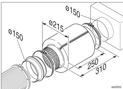
Za dodatno prigušivanje buke, u cijevi za odvod zraka može se postaviti prigušivač buke (dodatni pribor).
