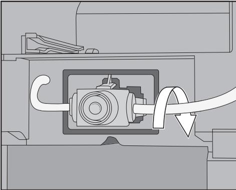
**Conseil :** Si nécessaire, tournez le conduit de lait vers l'arrière au niveau du raccord droit.
