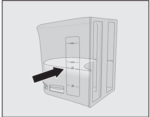
■ Remplissez le réservoir d'eau tiède jusqu'au repère **S**.
