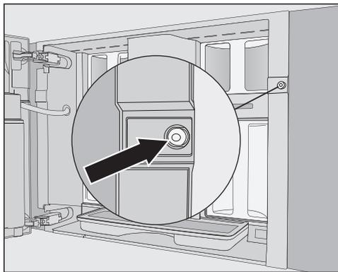
Un ergot en silicone rouge se trouve dans le trou de la vis, ce qui permet de sécuriser la porte de l'appareil pendant le transport et d'éviter ainsi les dommages lors du transport sur l'appareil.
