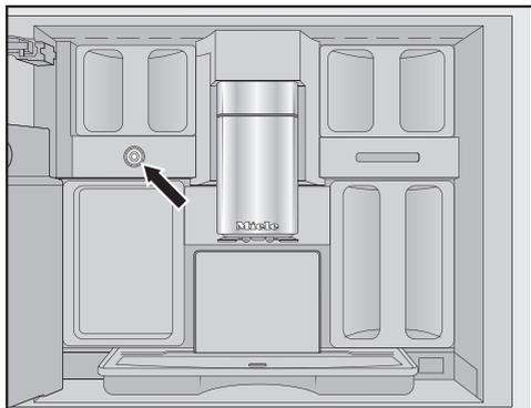
La vanne de lait est située sous le réservoir à grains gauche.
