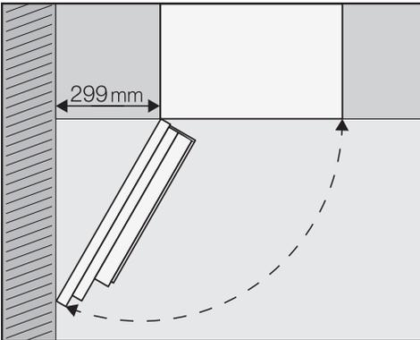
**Conseil :** Si une distance d'au moins 299 mm sépare le mur de la machine à café, la porte de l'appareil s'ouvre plus largement et la manipulation est simplifiée. Il est ainsi plus facile de retirer le réservoir à grains gauche, par exemple.
