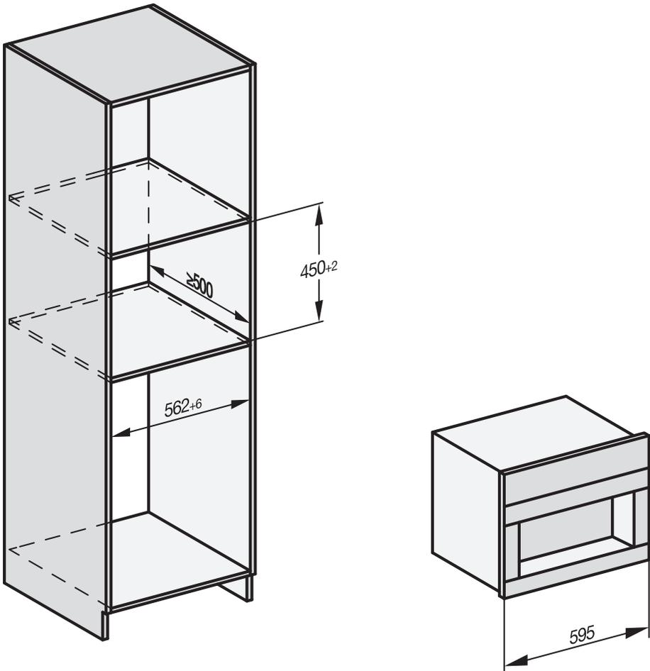
Une combinaison avec d'autres appareils à encastrer Miele est possible. Dans ce cas, il est impératif de prévoir un plancher intermédiaire fermé entre la machine à café et l'appareil situé en dessous. Une combinaison avec un tiroir chauffant Gourmet ou de mise sous vide encastrable ne requiert pas de plancher intermédiaire.
