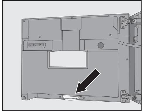
Le bac d'égouttage se situe en bas, au niveau de la face intérieure de la porte de l'appareil.
