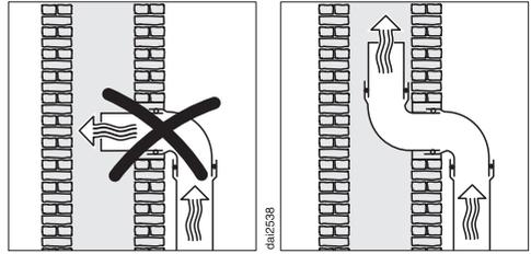
Ako se odvod zraka provodi kroz dimnjak, odvodni nastavak se mora usmjeriti u smjeru strujanja zraka.
