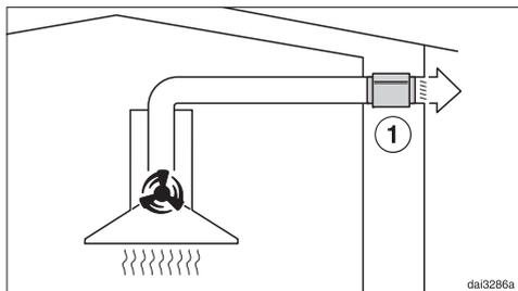
Kod načina rada na odvod zraka, prigušivač buke prigušuje kako zvukove ventilatora prema van tako i vanjske zvukove, koji putem cijevi za odvod zraka prodiru u kuhinju (npr. ulična buka). Stoga se prigušivač buke postavlja što je moguće bliže ispred izlaza zraka ①.
