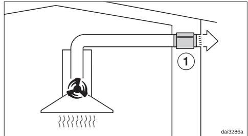
Der Schalldämpfer dämpft sowohl Gebläsegeräusche nach aussen als auch Aussengeräusche, die über die Abluftleitung in die Küche dringen (z. B. Strassenlärm). Dazu wird der Schalldämpfer möglichst nah vor dem Abluftaustritt ① positioniert.
