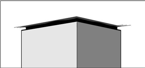
Zwischen Kamin und Decke kann ein **Distanzrahmen** montiert werden. Er kann verwendet werden, wenn aus optischen Gründen ein Abstand zwischen Decke und Kamin gewünscht wird (Schattenfuge). Dies kann zum Beispiel erforderlich sein, wenn die Decke nicht waagrecht oder uneben ist. Die Dunstabzugshaube wird mit den beiliegenden Ausgleichstreifen senkrecht ausgerichtet. Optische Unregelmäßigkeiten zwischen Kamin und Decke werden durch die Schattenfuge verdeckt.
