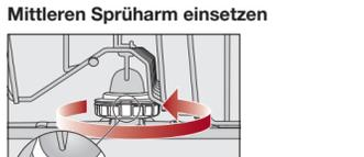
■ Setzen Sie den mittleren Sprüharm wieder ein und drehen Sie die Verschraubung gegen den Uhrzeigersinn bis sie einrastet. Achten Sie darauf, dass die Aussparungen in der Verriegelung übereinander liegen.
