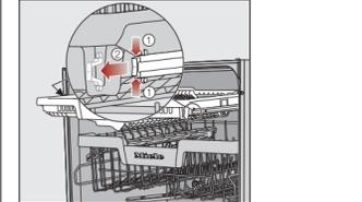
■ Drücken Sie die Sicherungskammern der Schienen an beiden Seiten der Besteckschublade zusammen ① und entnehmen Sie die Sicherungskammern ②.
