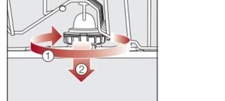
■ Drehen Sie die Verschraubung des mittleren Sprüharms im Uhrzeigersinn ① und nehmen Sie den Sprüharm ab ②.
