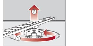
■ Drehen Sie die Verschraubung des unteren Sprüharms gegen den Uhrzeigersinn ① und ziehen Sie den Sprüharm nach oben ab ②.
