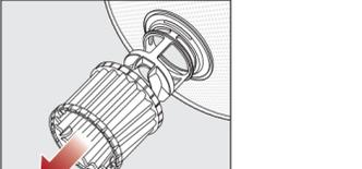
■ Zum Reinigen der Siebinnenseite ziehen Sie den Mikrofilter an dem Kunststoffing nach unten von der Siebkombination ab.
