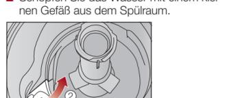
■ Drücken Sie die Verriegelung der Abdeckung der Ablaufpumpe nach innen ①.
