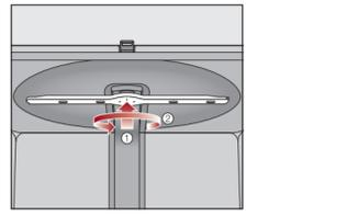
■ Drücken Sie den oberen Sprüharm hoch ①, damit die innere Verzahnung einrastet, und schrauben Sie ihn gegen den Uhrzeigersinn ab ②.
