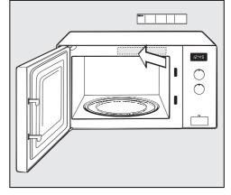
Collez le mode d'emploi abrégé en veillant à ne pas obstruer les ouvertures d'aération.
