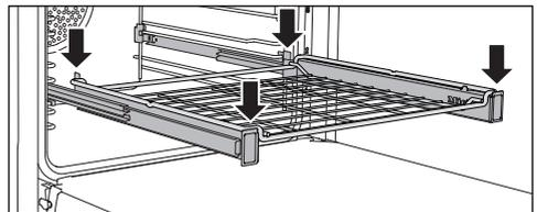
La capacidad máxima de carga de las guías telescópicas FlexiClip es de 15 kg.
