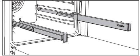
Puede montar las guías telescópicas FlexiClip en cualquier nivel.
