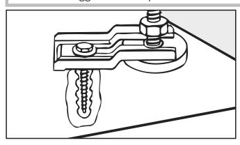
Fissare l'essiccatoio dai piedini assolutamente con griffe di ancoraggio (accessori).
