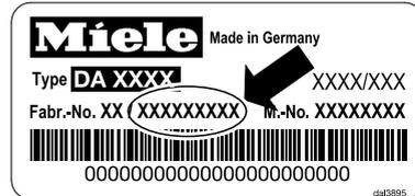
Le mot de passe de la hotte correspond aux neuf derniers chiffres du numéro de fabrication qui se trouve sur la plaque signalétique.
