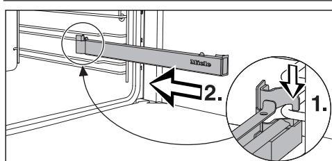
■ Hekt FlexiClip-skinnen foran på den nederste stangen i rillehøyden (1.) og skvv den langs stangen inn i ovnsrommet (2.).
