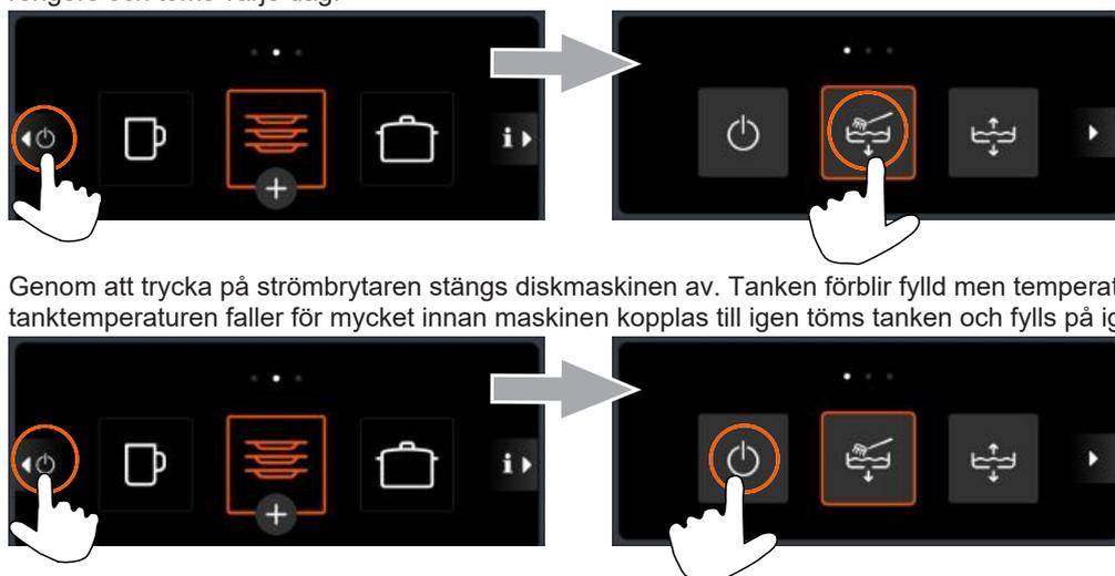
Genom att trycka på strömbrytaren stängs diskmaskinen av. Tanken förblir fylld men temperaturen bibehålls inte. Om tanktemperaturen faller för mycket innan maskinen kopplas till igen töms tanken och fylls på igen automatiskt.
