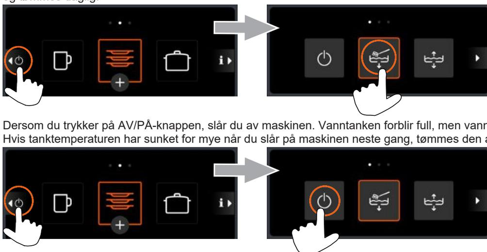
Dersom du trykker på AV/PÅ-knappen, slår du av maskinen. Vanntanken forblir full, men vannet holdes ikke på samme temperatur. Hvis tanktemperaturen har sunket for mye når du slår på maskinen neste gang, tømmes den automatisk og fylles opp på nytt.
