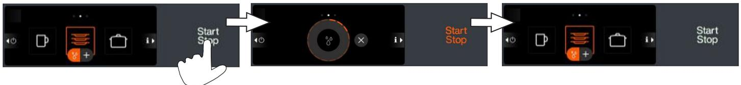
Fem sekunder efter blötlägningsprogrammets start cirkulerar spolpumpen tankvattnet i sju sekunder. Efter cirkulationen börjar blötläggningstiden på fem minuter. Tankvattnet fuktar disken och mjukar upp smutsen.
