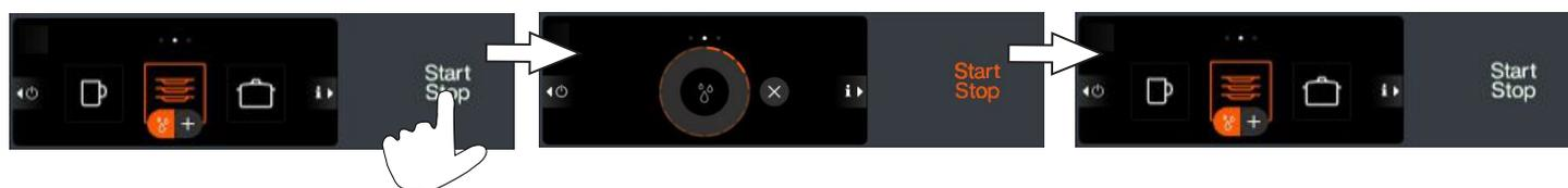
Cinco segundos después del inicio del programa de remojo, la bomba de lavado hace circular el agua del tanque durante 7 segundos. Tras la circulación del agua comienza el tiempo de remojo de 5 minutos. El agua del tanque empapa el producto de lavado y humedece la suciedad.
