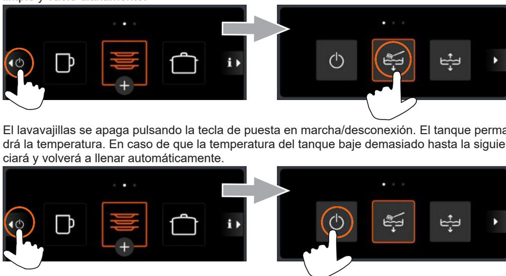
El lavavajillas se apaga pulsando la tecla de puesta en marcha/desconexión. El tanque permanece lleno. Sin embargo, no se mantendrá la temperatura. En caso de que la temperatura del tanque baje demasiado hasta la siguiente puesta en marcha, la máquina se vaciará y volverá a llenar automáticamente.
