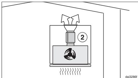
En mode évacuation, le réducteur de bruit se trouve entre le raccord d'évacuation et la grille de sortie ②. Vérifiez l'espace de montage.
