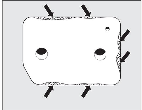
Se aprecian imprecisiones de ajuste en los bordes laterales.
