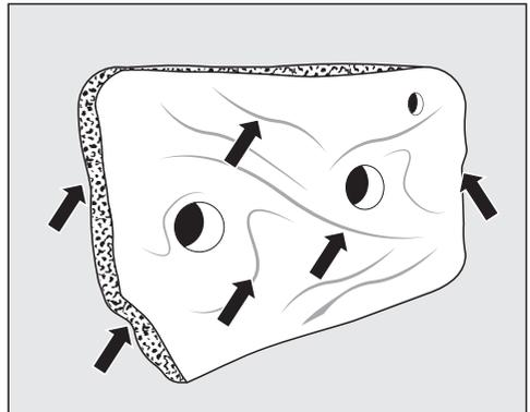
Se observan deformaciones en los bordes laterales y en todo el filtro del zócalo.
