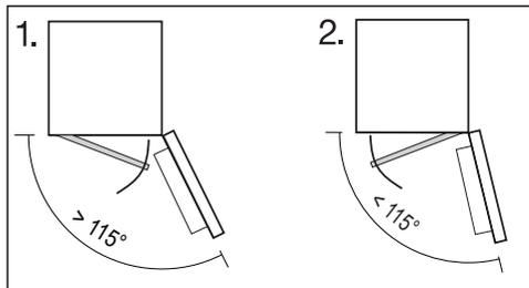
Je nach Öffnungswinkel der Gerätetür ist ein Anschlagwechsel der Gefrierfachtür notwendig.
