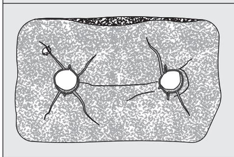
Les fentes, fissures et marques sont visibles sur les faces avant et arrière.
