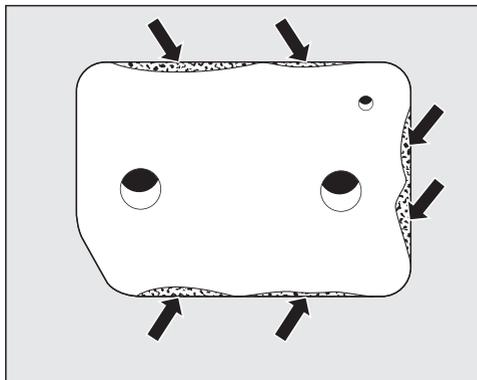
⚠ Dommages provoqués par un filtre de socle endommagé ou usé. L'échangeur thermique est encrassé et peut être endommagé. Vérifiez le filtre de socle conformément à la section "Remplacer le filtre de socle" au chapitre "Correction des problèmes". Remplacez le filtre de socle, si nécessaire.
