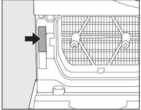
Le retrait du support entraîne l'activation d'un élément de sécurité (flèche). L'élément de sécurité empêche la fermeture du panneau de socle sans le support inséré. L'insertion du support entraîne la désactivation de l'élément de sécurité.
