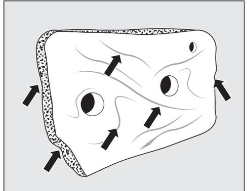
Les déformations sont visibles sur les bords latéraux et sur l'ensemble du filtre du socle.
