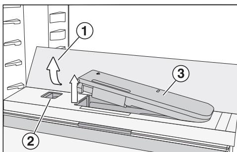
■ Нажмите на уголки стеклянной полки ①, расположенные сзади с внешней стороны.
