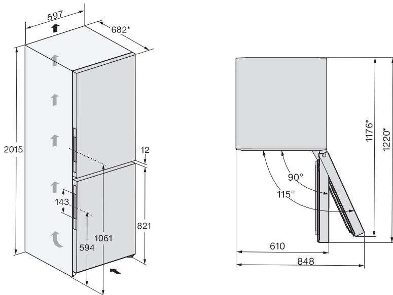
\* Размер без смонтированных проставок для соблюдения расстояния от стены. При использовании прилагаемых проставок глубина прибора увеличивается на 15 мм.
