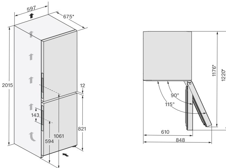
\* Размер без смонтированных прокладок для соблюдения расстояния от стены. При использовании прилагаемых прокладок глубина прибора увеличивается на 15 мм.
