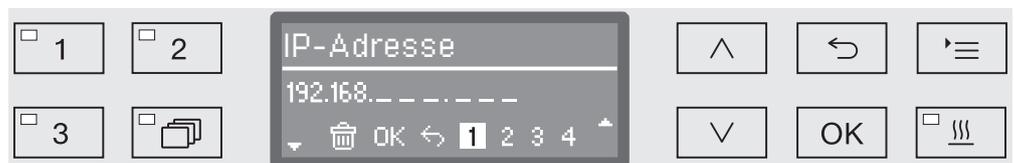
In der mittleren Zeile wird die aktuelle Einstellung ausgegeben. Diese kann mit den Optionen aus der unteren Zeile bearbeitet werden. Die oberste Zeile nennt die jeweils ausgewählte Option aus der unteren Zeile. Nachfolgende Eingabemöglichkeiten stehen zur Verfügung:
