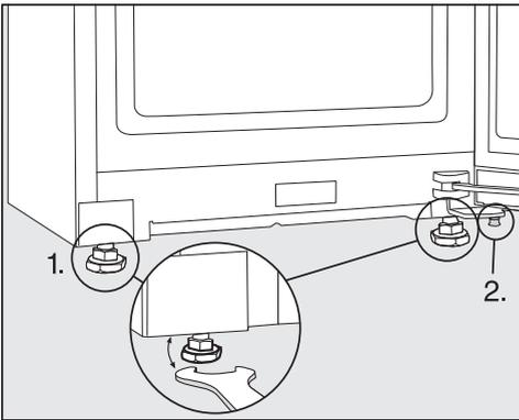
■ Regolare l'apparecchio con una livella a bolla d'aria e la chiave a forcina fornita e sostenere lo sportello.
