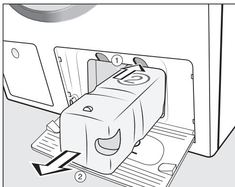
① Premere il pulsante giallo sopra la cartuccia per disattivare il dispositivo di blocco.
