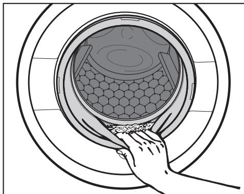
■ Controllare se sotto la guarnizione di gomma dello sportello si sono depositati oggetti estranei.
