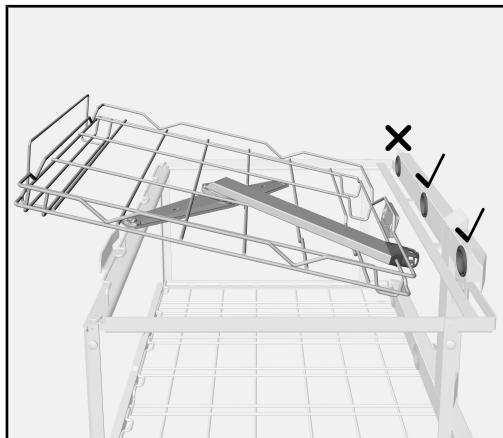
将 2/3 液位计 A 606 插入移动设备 A 503 的顶层。
