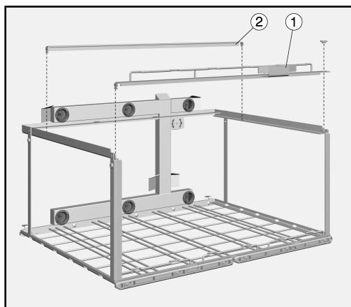
Чтобы иметь возможность ставить на нижний уровень особо высокие модули, можно снять рейку ① тележки.
