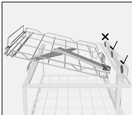
2/3úroveň A 606 lze nasadit v horní úrovni vozíku A 503. Připojovací hrdlo úrovně lze spojit s prostřední nebo pravou vodní přípojkou vozíku. Vedle 2/3úrovně lze nasadit další modul. Aby nebylo blokované ostřikovací rameno 2/3úrovně, musí se vozík používat bez přepážky v horní úrovni.
