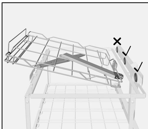
Poziom 2/3 A 606 zakłada się w górnym poziomie wózka A 503. Króciec przyłączeniowy poziomu może zostać połączony ze środkowym lub prawym spręgłem wodnym wózka. Obok poziomu 2/3 można założyć kolejny moduł.
