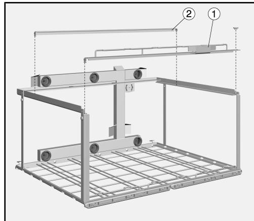
Na górnym poziomie wózka jest umieszczona poprzeczka ②. Poprzeczka zapobiega przechyleniu modułu na dolnym poziomie, gdy zostanie on wyciągnięty ze sprzęgła wodnego.
