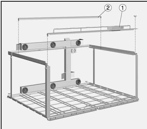
На верхнем уровне тележки установлена одна распорка ②. Распорка предотвращает опрокидывание модулей на нижний уровень, когда их нужно извлечь из стыковочных узлов для воды. Если на нижнем уровне необходимо обработать более высокие предметы, распорку необходимо снять.
