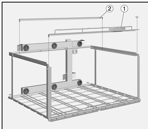
V horní úrovni vozíku je nasazená příčka ②. Příčka brání převržení modulů do spodní úrovni, když jsou vytahovány z vodní přípojky. Když se ve spodní úrovni mají připravovat vyšší předměty k mytí, musí se příčka vymontovat.
