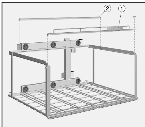
Alt seviyeye bilhassa yüksek modülleri yerleştirebilmek için, mobil raf ünitesinin çıtası ① çıkarılabilir.
