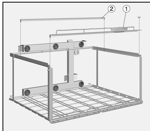
在移动设备的顶层插入支杆 ②。当模块与水连接断开时，支杆可防止模块掉入底层。
