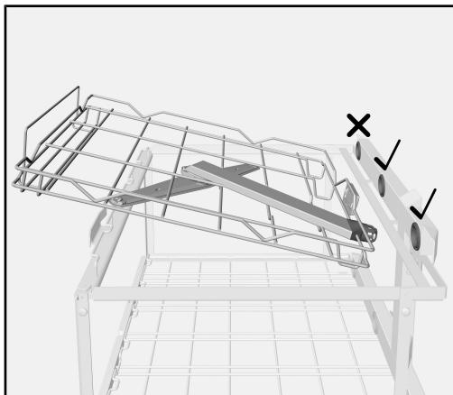
A 606 2/3 seviye A 503 mobil raf ünitesinin üst seviyesine takılabilir. Seviyenin bağlantı uçları mobil raf ünitesinin ortadaki ve sağdaki su bağlantısına bağlanabilir. 2/3 seviyenin yanında ek bir modül takılabilir. 2/3 seviyenin püskürme kolumnun engellenmemesi için mobil raf ünitesinin üst seviyedeki çita olmaksızın kullanılması gereklidir.
