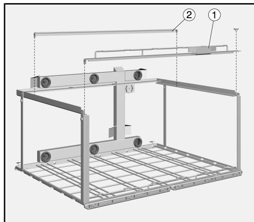
Um besonders hohe Module in der unteren Ebene einsetzen zu können, kann die eine Leiste ① des Wagens entfernt werden.
