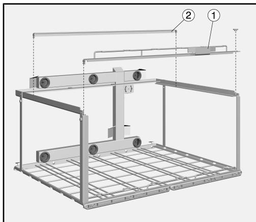
为了将特别高的模块插入底层，可以去除掉移动设备上的条带 ①。
