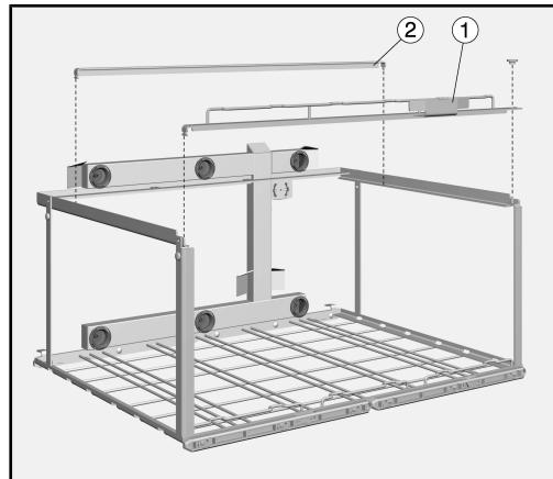
バー②は、モバイルユニットの上のレベルに取り付けます。モジュールを給水接続から切り離したときに、傾いて下のレベルに落ちるのを防ぐのがバーの役目です。背の高い搭載物を下のレベルに入れて再生処理する場合は、バーを取り外す必要があります。
