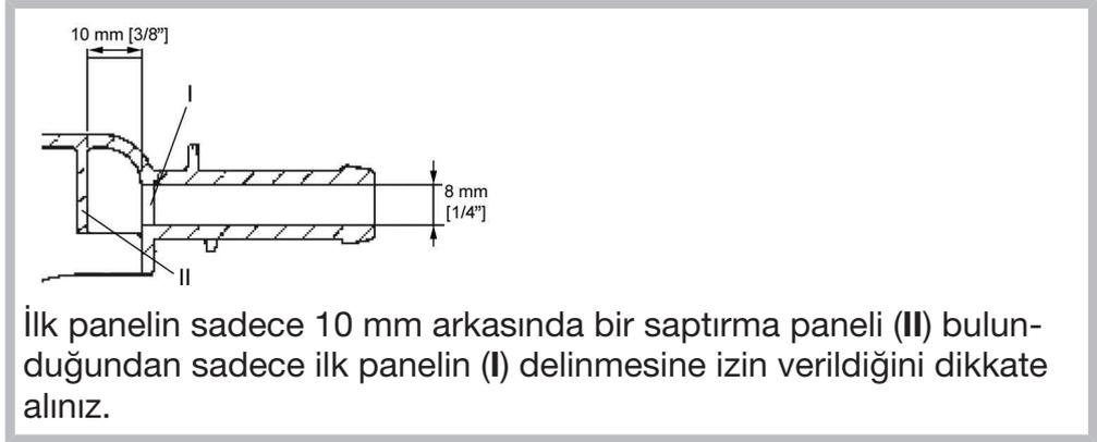
**3** ila **12** bağlantıları sıvı deterjan için öngörülmüştür. Bu bağlantılara su girişli yüksek basınç dozaj sistemleri bağlanmamalıdır. Bağlantı uçları kapalıdır ve bağlanmadan önce küçük bir testere ile hortum çapında kesilmelidir.
