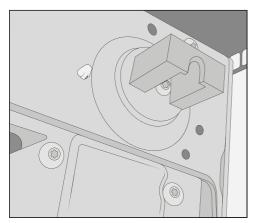
■ Para a posição segura do micro-ondas garanta que o pino pequeno para o posicionamento está encaixado antes de voltar a fixar os pés.
