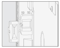
■ Tenha em atenção ambas as medidas de espessuras da parede que podem ser visualizadas na estrutura, na parte posterior do aparelho.
