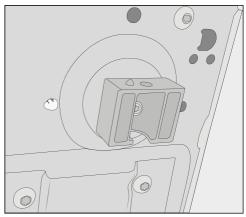
■ Desenrosque os 4 pés do aparelho na base do aparelho e rode os pés um quarto de volta para a posição superior.
