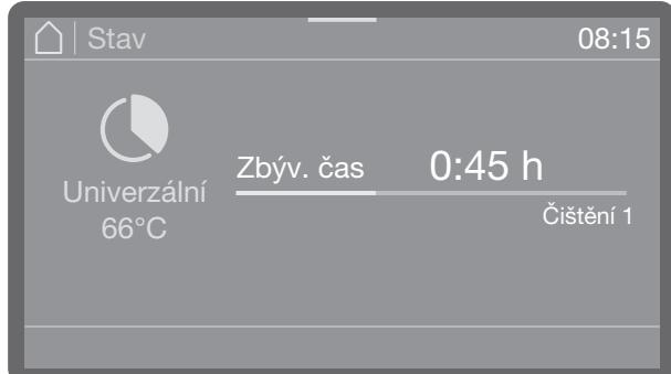
V průběhu programu lze zkontrolovat parametry programu jako např. žádanou a skutečnou teplotu.
