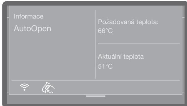
Na horním okraji zobrazení na displeji se zobrazuje barevný proužek. Když ho stisknete a přetáhnete dolů, otevře se stavové okno. Tak si můžete nechat zobrazit různá stavová hlášení, například k probíhajícímu programu.
