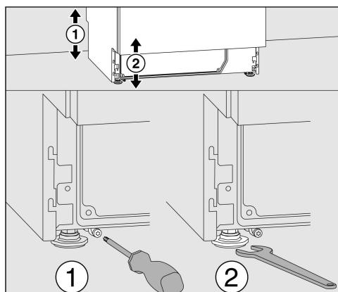
Pomocí noh přístroje lze nastavit výšku 820–880 mm. Myčky nádobí s horním krytem jsou o 15 mm vyšší.
