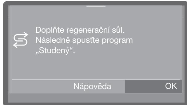
Jste-li při zapnutí nebo na konci programu upozorněni na chybu nebo závadu a je Vám nabídnuto tlačítko Návod, můžete se stisknutím tlačítka Návod nechat vést jednotlivými kroky, jež je třeba provést pro odstranění chyby nebo závady.
