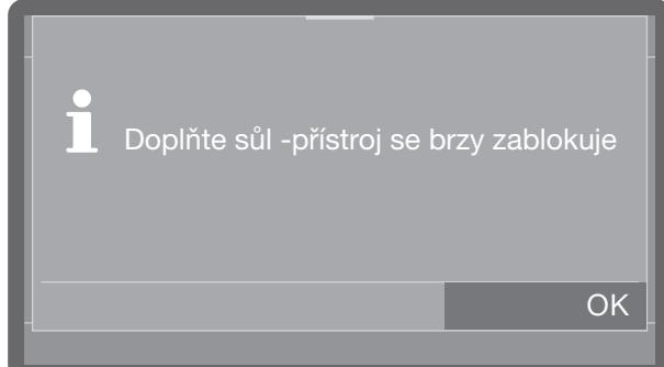
Symbol označuje systémová hlášení. Ta informují o probíhajícím procesu a stavu přístroje. Systémová hlášení se vydávají jednotlivě na konci programů. Pokud existuje více stavových hlášení, zobrazují se postupně a musíte je jednotlivě potvrdit tlačítkem OK.
