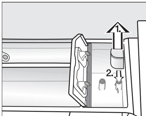
1. Retirez le tube d'aspiration de son logement ☼ et nettoyez-le à l'eau chaude. Nettoyez également le tuyau sur lequel le tube d'aspiration est fixé.
