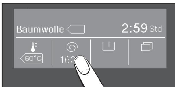
Les touches sensibles et vous permettent de modifier la température et la vitesse. À l'aide des touches sensibles ou , sélectionnez *Pré-lavage* ou *Rinçage supplémentaire*.
