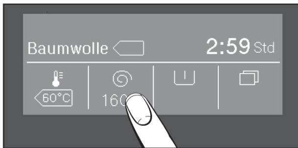
Mit den Sensortasten und können Sie die Temperatur und die Drehzahl ändern. Mit den Sensortasten oder wählen Sie *Vorwäsche* oder *Spülen plus*.
