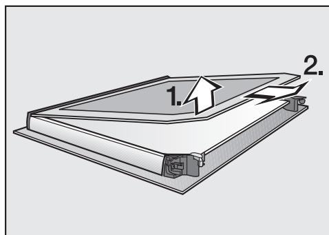
■ Unutarnju ploču vrata **blago** podignite i izvucite iz plastične letvice.
