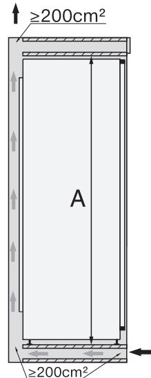
\* Η κατανάλωση ρεύματος που αναφέρεται υπολογίστηκε με βάθος εσοχής 560 mm. Η συσκευή μπορεί να λειτουργήσει σε βάθος εσοχής 550 mm, έχει όμως ελάχιστα αυξημένη κατανάλωση ρεύματος.
