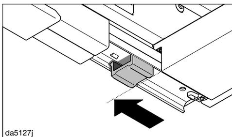
■ Glissez les butées de profondeur vers l'avant jusqu'à la position indiquée.
