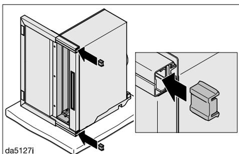
■ Insérez les butées de profondeur dans les coulisses de l'écran anti-buées par l'arrière. La lèvre de la butée de profondeur est dirigée vers l'arrière.
