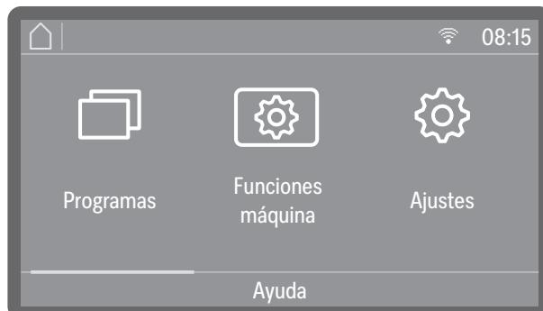
En el caso de lavadoras desinfectadoras con conectividad, en la parte superior del display aparece el ícono de la interfaz disponible. WiFi significa que hay conexión WiFi disponible; L significa que existe una conexión LAN por cable. Si la lavadora desinfectadora no puede establecer una conexión WiFi con el router, el símbolo aparece tachado ~~WiFi~~.
