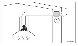
En mode évacuation, le réducteur de bruit insonorise aussi bien les bruits du ventilateur vers l'extérieur que les bruits extérieurs qui parviennent par la conduite d'évacuation d'air (par ex. bruits des voitures). Aussi le réducteur de bruit doit être posé le plus près possible de la sortie d'évacuation d'air (1).
