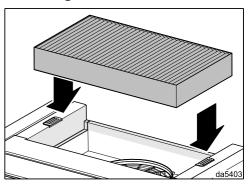
■ Positionnez le filtre à charbon actif dans le logement situé sur la partie supérieure de la hotte.
