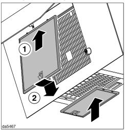
■ Insérez les filtres à graisses.
