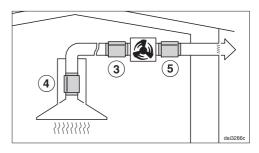
Lors du fonctionnement avec un ventilateur externe, les bruits du ventilateur peuvent être réduits vers l'extérieur et dans la cuisine.
