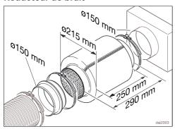
Un réducteur de bruit peut être installé dans la conduite d'évacuation d'air (accessoire en option) pour réduire davantage encore le bruit.
