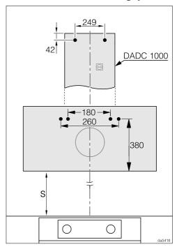
■ Si le mur doit être percé à l'avance, les cotes d'espacement des perçages sont indiquées ici (vis Ø 5 mm).
