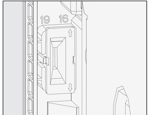
■ Enfichez l'adaptateur de manière à ce que la flèche soit pointée sur les chiffres indiquant l'épaisseur de paroi appropriée.
