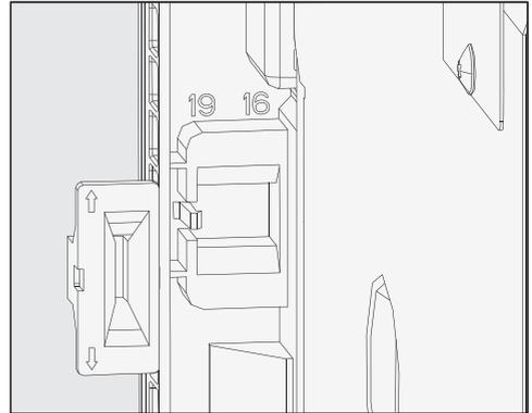
■ Tenez compte des deux cotes d'épaisseurs de parois visibles dans le cadre au dos de l'appareil.
