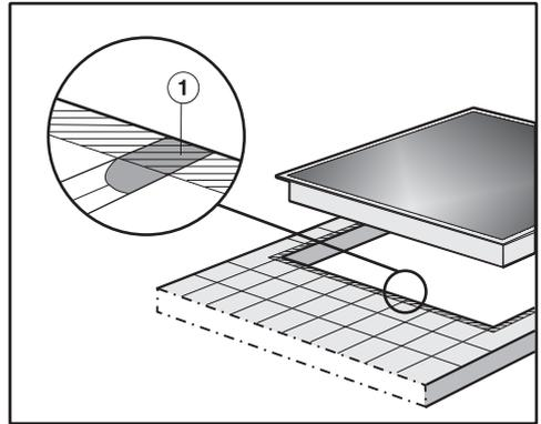
Les joints ① et la zone hachurée sous la table de cuisson doivent former une surface lisse et plane afin que la table de cuisson s'encastre bien sur son support et que le joint d'étanchéité situé sous tout le pourtour de la table de cuisson assure une étanchéité suffisante avec le plan de travail.
