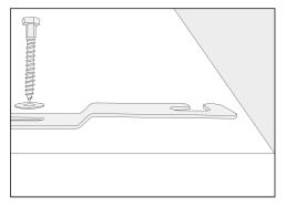
Montez l'étrier de fixation avec les vis hexagonales et les rondelles.
