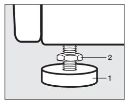
Desserrez le contre-écrou 2 dans le sens des aiguilles d'une montre à l'aide de la clé à fourche fournie. Dévissez le contre-écrou 2 et le pied 1 en même temps.
