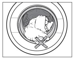
Vérifiez qu'aucune pièce de linge n'est coincée entre la porte et le joint cuve-façade.
