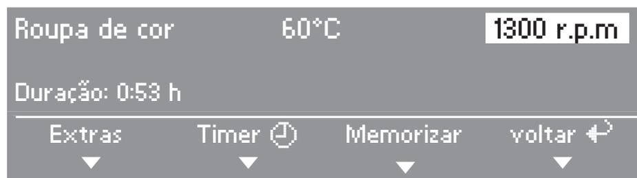
Rodando o selector multifunções pode seleccionar os diferentes componentes do programa, programa, temperatura e velocidade de centrifugação.
