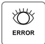
Cuando esta luz indicadora está encendida (pero no parpadeando) significa que falta papel o está a punto de terminarse o la tapa de la impresora está abierta. Cuando parpadea, indica que hay un error. (Ver "Parpadeo LED DE ERROR" en Capítulo 11.1.). Si ve que esta luz parpadea, apague la impresora durante unos segundos y luego vuelva a encenderla. Si todavía sigue parpadeando, llame al servicio.
