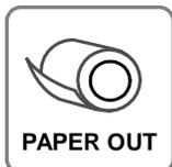
Cuando esta luz indicadora está encendida, indica que el papel está a punto de terminarse. Coloque un rollo de papel. Cuando se encienden las luces de los indicadores de ERROR y FINAL DEL PAPEL, significa el final del papel. Instale el rollo de papel. (Ver "Instalación del Rollo de Papel" en Capítulo 5.)
