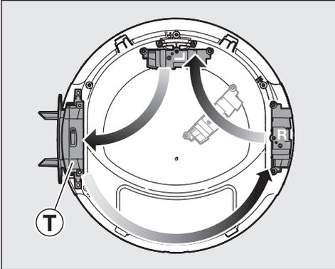
Disposition de la charnière de porte et des caches avec ouverture à droite (exécution d'usine).
