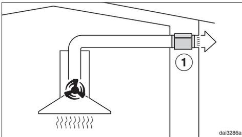
No modo de exaustão, o silenciador atenua tanto o ruído do ventilador para o exterior, como o ruído do exterior que entra na cozinha através do tubo de exaustão (p. ex. o ruído da rua). Para isso, o silenciador deve ser posicionado o mais próximo possível da saída de ar (1).
