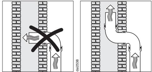
Quando o ar for evacuado através de uma chaminé, o bocal de saída do tubo deve ser orientado no sentido do fluxo.
