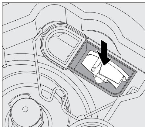
Под обратным клапаном находится крыльчатка сливного насоса (стрелка).
