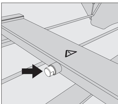
На входе для измерения давления ни в коем случае не должно быть обрабатываемого материала, подключённых промывочных устройств и пр. После проведения измерения вход нужно снова закрыть винтовой заглушкой.
