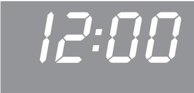
Nach dem Anschluss an das Elektronetz leuchtet **12:00** im Display und
