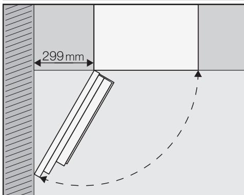
**Savet:** Ako između zida i aparata za kafu postoji odstojanje od najmanje 299 mm, vrata uređaja se mogu šire otvoriti i rušovanje je jednostavnije. Na primer, tako ćete lakše moći da izvadite levu posudu za kafu u zrnu.
