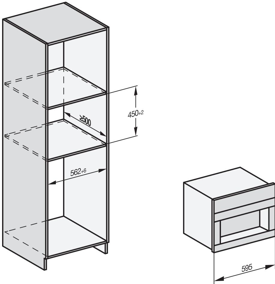
Kombinacija sa drugim Miele ugradnim uređajima je moguća. Pri tom aparat za kafu mora sa donje strane da se odvoji zatvorenom pregradom. Za kombinaciju sa grejnom fiokom/ugradnom fiokom za vakuumiranje neophodna je horizontalna pregrada.
