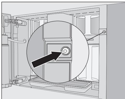
U otvoru za zavrtanj se nalazi crveni silikonski nastavak koji štiti vrata uređaja tokom transporta i na taj način sprečava oštećenja na uređaju prilikom transporta.
