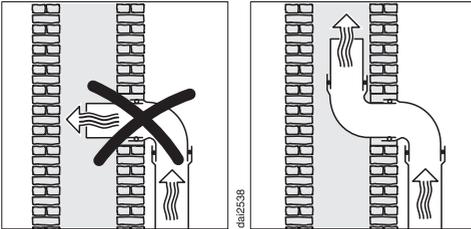
Wenn die Abluft in einen Abluftkamin geführt wird, muss der Einführungsstutzen in Strömungsrichtung gelenkt werden.
