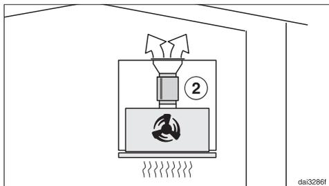
Bei Umluftbetrieb wird der Schalldämpfer zwischen Ausblasstutzen und Ausblasgitter positioniert ②. Prüfen Sie den Einbauraum.
