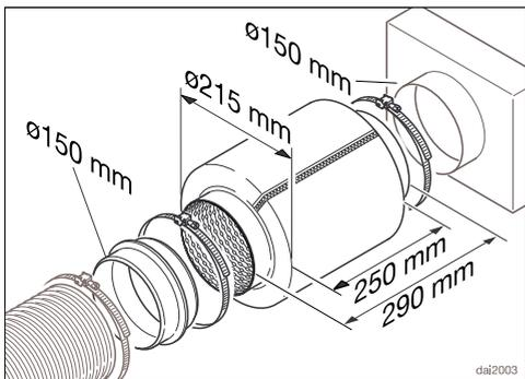
Zur zusätzlichen Schalldämpfung kann in die Abluftleitung ein Schalldämpfer eingesetzt werden (nachkaufbares Zubehör).
