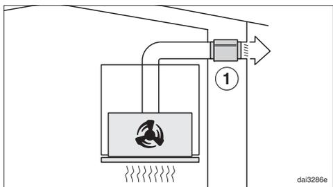
Bei Abluftbetrieb dämpft der Schalldämpfer sowohl Gebläsegeräusche nach aussen als auch Aussengeräusche, die über die Abluftleitung in die Küche dringen (z. B. Strassenlärm). Dazu wird der Schalldämpfer möglichst nah vor dem Abluftaustritt ① positioniert.
