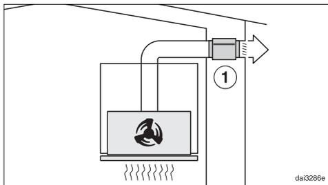
Con il funzionamento a evacuazione il silenziatore attutisce i rumori dell'aspiratore verso l'esterno e anche i rumori che dall'esterno penetrano in cucina attraverso il condotto di sfiato dell'aria (ad es. i rumori del traffico). Posizionare il silenziatore il più vicino possibile al bocchettone di uscita dell'aria ①.
