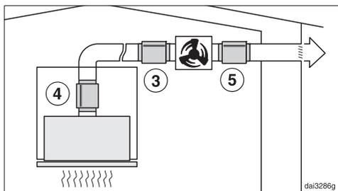
Per il funzionamento con un aspiratore esterno, i rumori dell'aspiratore verso l'esterno e in cucina possono essere ridotti al minimo.
