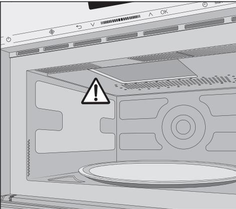
N'enlevez pas le cache de protection de l'orifice de sortie des micro-ondes dans l'enceinte.
