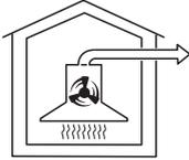
Die angesaugte Luft wird durch den Fettfilter gereinigt und aus dem Gebäude geleitet.
