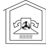
Die angesaugte Luft wird durch den Fettfilter und zusätzlich durch einen Geruchsfilter gereinigt. Anschliessend wird die Luft in die Küche zurückgeführt.
