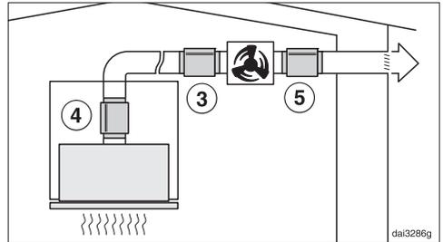
En caso de funcionamiento con un motor externo es posible minimizar los ruidos del motor hacia fuera y en la cocina.
